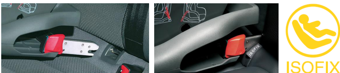
Figure 2 : Système de fixation ISOFIX
